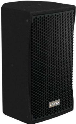
BS-8 是一个紧凑型二分频无源扬声器。由单 8"(2" 音圈) 低频驱动器以及 1" 高频驱动器组成，具有 90°x60° 可旋转号筒并有很广泛的适用范围从固定安装，前置补声以及作为舞台监听被使用。
