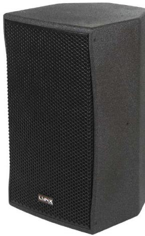
BS-12 是一个紧凑型二分频无源扬声器。由单 12"(3" 音圈) 低频驱动器以及 1 英寸高频单元组成，具有 90°x60° 可旋转号筒并有很广泛的适用范围从固定安装，前置补声以及作为舞台监听被使用。
